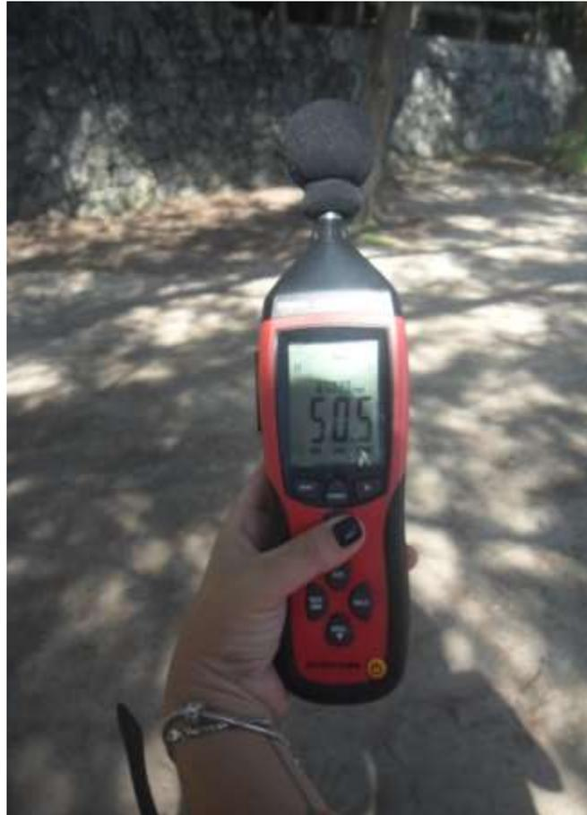
Figura 228: Decibelímetro Instruterm, modelo DEC-490, utilizado nas medições.
