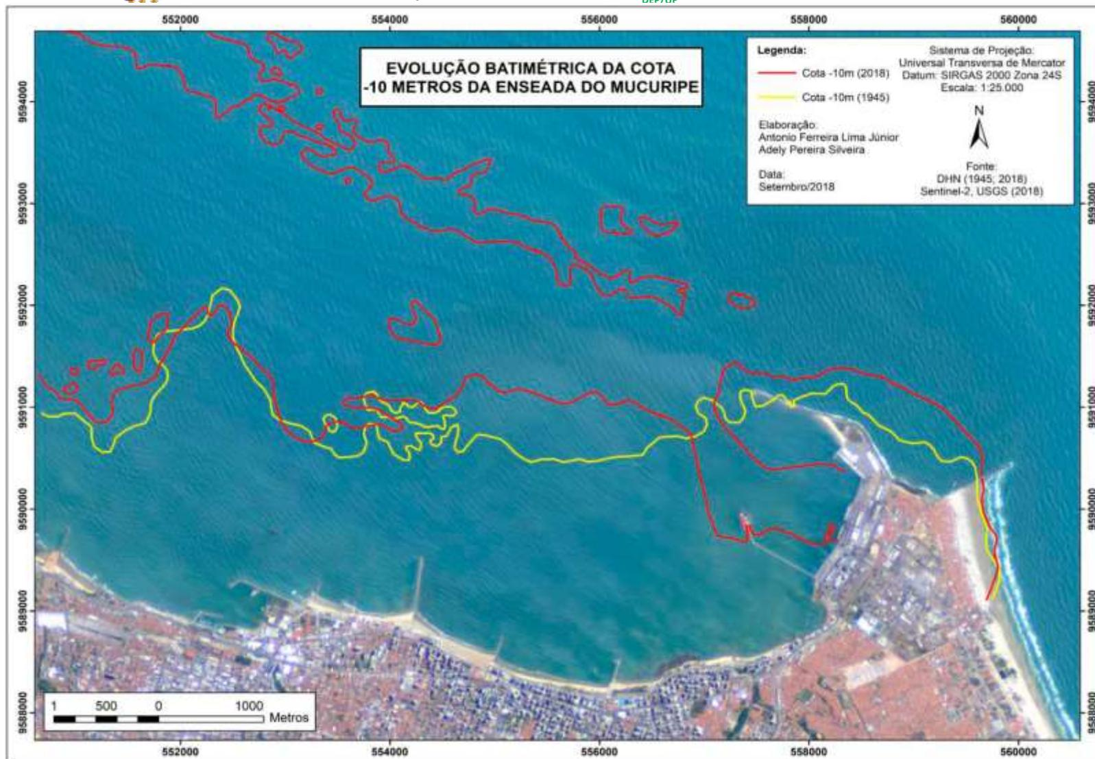
Figura 25: Evolução Batimétrica da Cota -10 metros da Enseada do Mucuripe entre 1945 e 2018. Fonte: DHN (1945, 2018), Sentinel 2 (2018).
